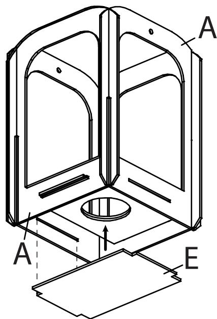
Drücke die Teile **A** etwas auseinander und schiebe den **Teil E** in die **Schlitte** der Teile **A**.
