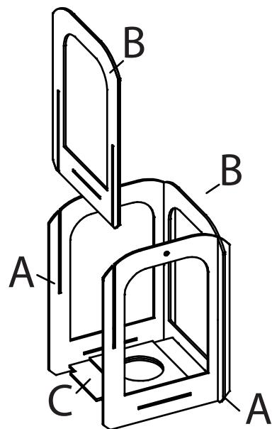
Stecke die Teile **C** und **D** zwischen die Teile **A**. Stecke anschließend **Teil B** in die Teile **A**. Damit du Teil **C** in den vorgesehenen Schlitz geben kannst, biege **Teil B** beim reinschieben etwas **nach außen**.
