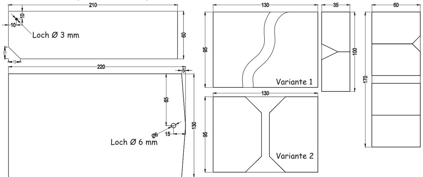
gerade Kanten: mit Bleistift und Lineal auf die Teile (A) bis (E) übertragen.
